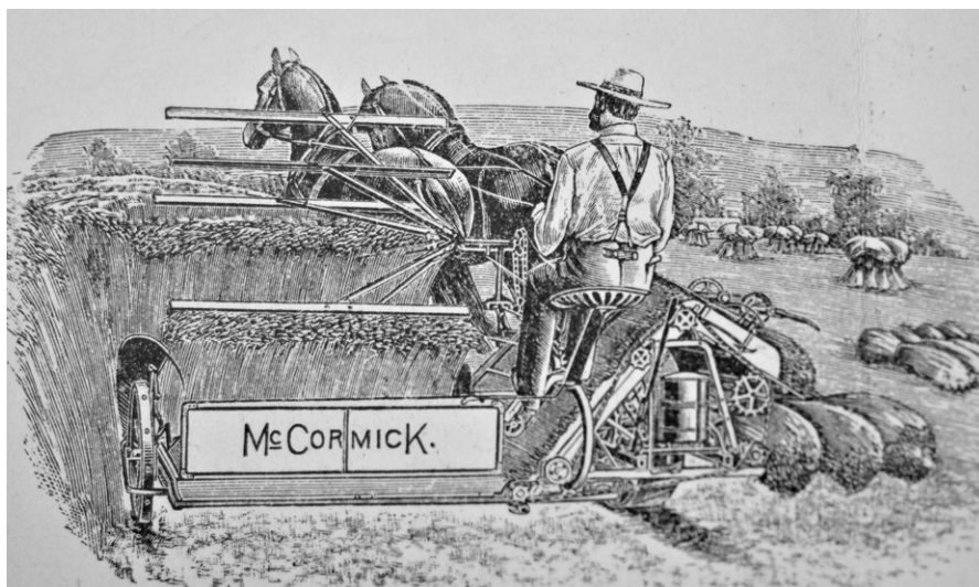
Počátky zemědělské mechanizace. McCormikův žací stroj s vazačem snopů na vyobrazení z Ottova slovníku naučného. Poprvé byl u nás zkoušen roku 1850 u Znojma na statku G. Suttnera, který jej přivezl z USA. Vlastenekohospodářská společnost hned v následujícím roce zakoupila další exemplář a pro osvětové i propagační účely ho předváděla na zemědělské výstavě v Praze.
