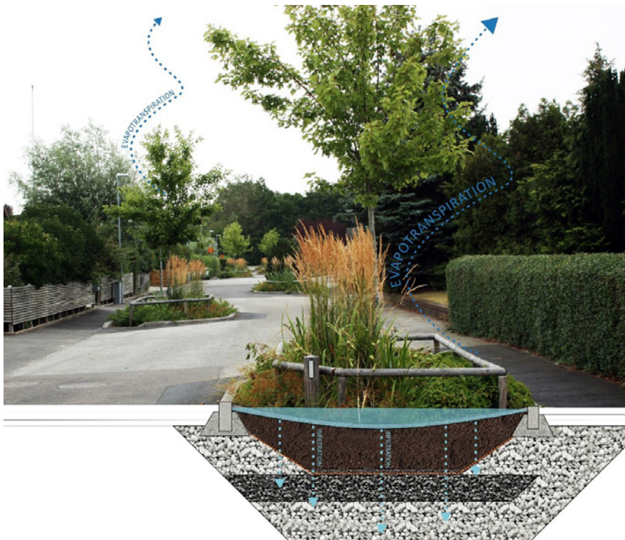
Obr. 5: Příklad tzv. Bluegreengrey systému (BGG systému), který demonstruje integraci modré, zelené a šedé infrastruktury. Rundelsgatan, Vellinge. Ilustrace: Hanna Alfredsson
